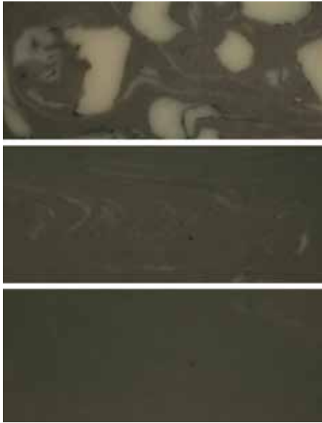
Bild 4. Proben aus dem Schneckenziehversuch: Sichtbare weiße Feststoffe am Anfang der zweiten Schneckenstufe (oben), disperses Aufschmelzen (Mitte) und vollständige Plastifizierung am Extruderaustritt (© KTP, esde)
